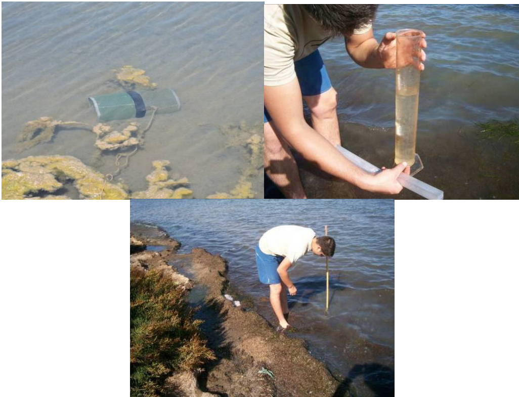
Figura 13. Minnow-trap en funcionamiento; Medición de la salinidad con la ayuda de un densímetro; Medición de la profundidad con una baliza portátil calibrada.
