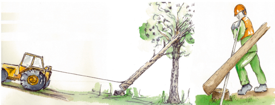
Fig 10 Formas seguras de apeaar un árbol enganchado. Izquierda, cable y tractor.
