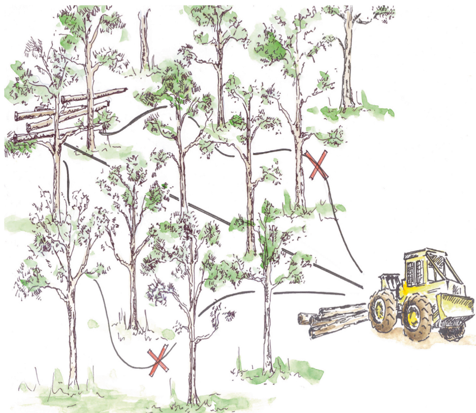
Fig 53. En el arrastre se deben evitar trayectorias curvas que puedan dañar la masa remanente.
