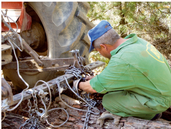
Fig 49. Cables en mal estado y enredados.
