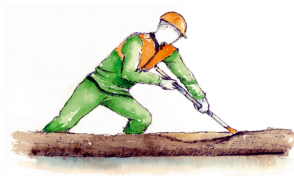
Fig 16. Empleo del cuchillo descortezador.
