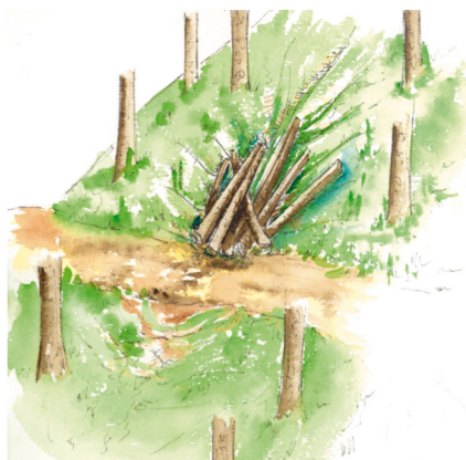
Fig 27. Cargadero inapropiado en la red de drenaje secundaria.
