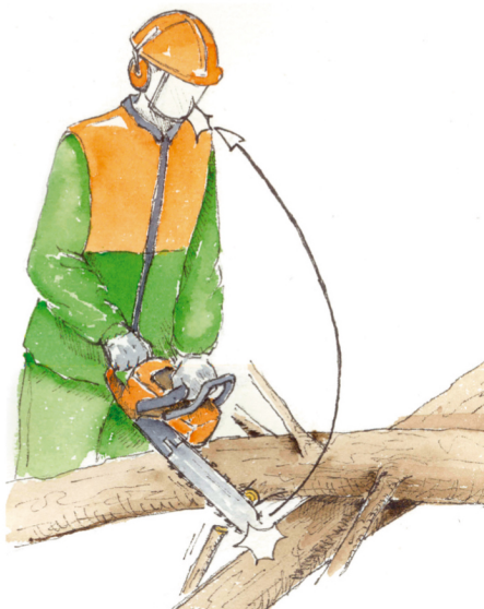
Fig 32. Rebote de la motosierra, un riesgo frecuente y muy peligroso.
