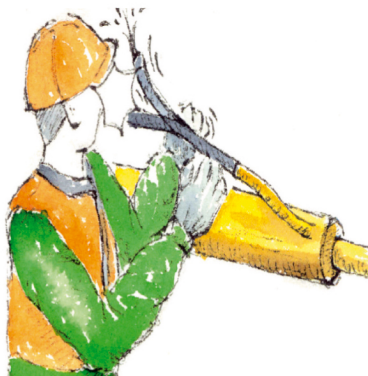
Fig 44 Antes de manipular el sistema hidráulico se parará el motor.
