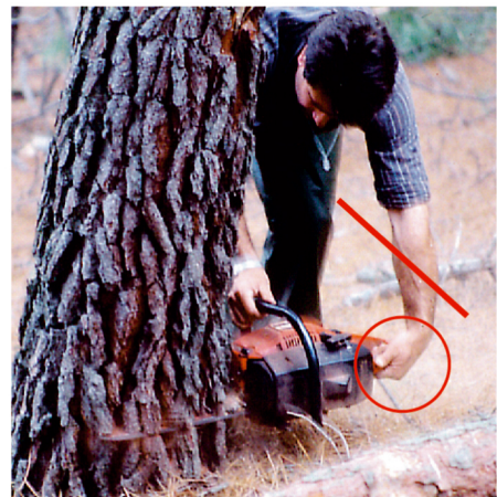
Fig 14 Trabajo peligroso: Colgante, muñeca doblada, espalda, forzada y sin equipo de protección individual.
