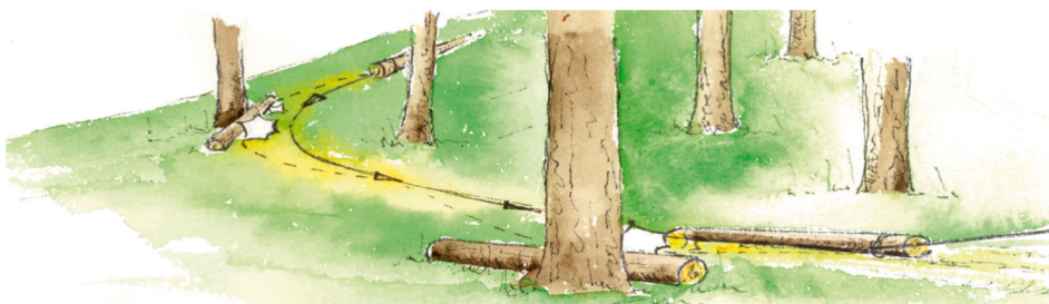
Fig 26. El uso de patines protege a la masa remanente en los giros del arrastre de fustes.
