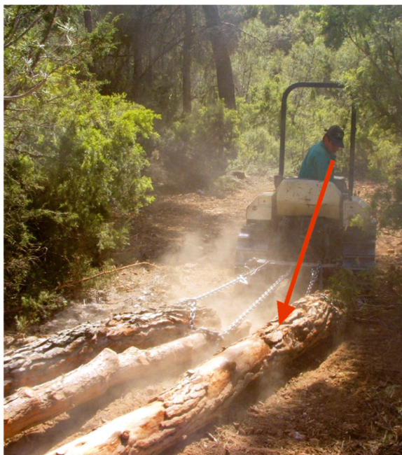
Fig 51. Eslinga y operación de arrastre. El maquinista no pierde contacto visual con la carga
