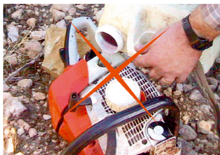
Fig 38. Usar envases que eviten derrames al suelo.
