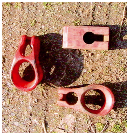
Fig 50. Forma de enganchar el cable de acero en el chóker y distintos tipos de choker.
