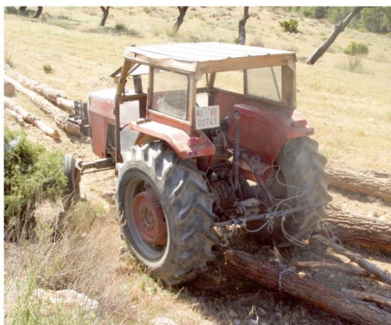
Fig 46. Tractor agrícola no adaptado para uso forestal.
