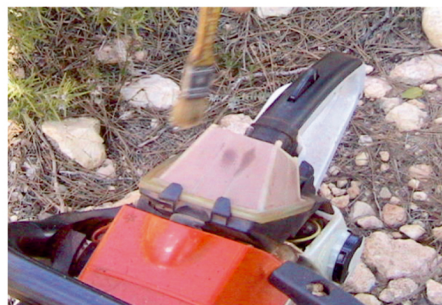
Fig 36. Limpieza filtro del aire
