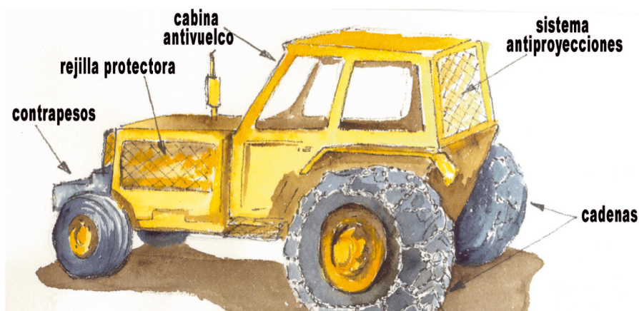
Fig 45. Adaptaciones del tractor agrícola para uso forestal.
