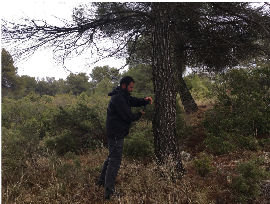
FOTO 4. Obtención de cores con barrena Pressler
