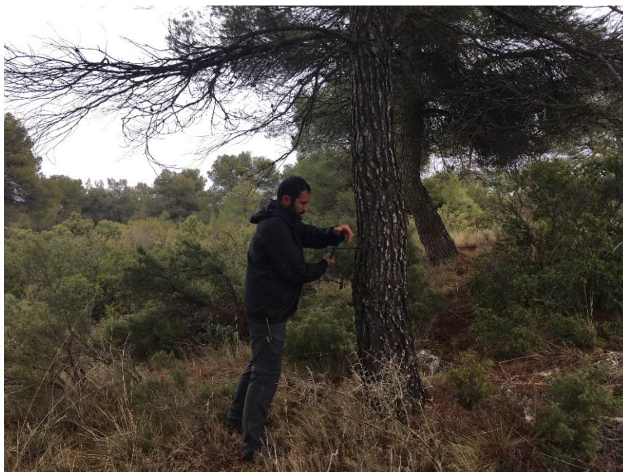
FOTO 8. Obtención de cores con barrena pressler
